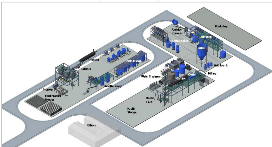
图8: HPA工厂总平面图及3D面
