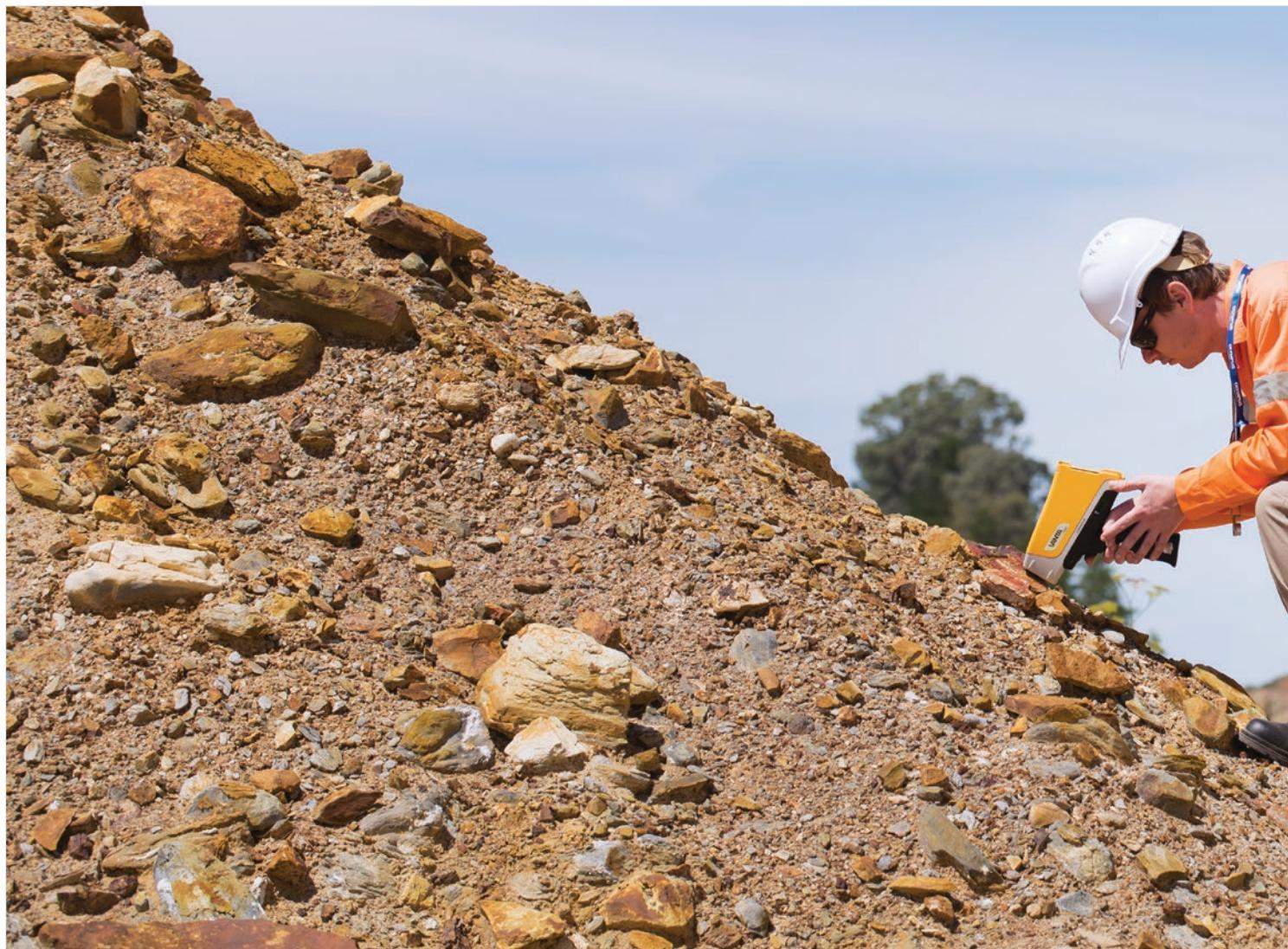
O analisador portátil por XRF Vanta™ fornece as medições de elementos de forma imediata para uma grande variedade de aplicações geoquímicas. Os analisadores Vanta são potentes e flexíveis durante todo o ciclo de fontes mineral.
